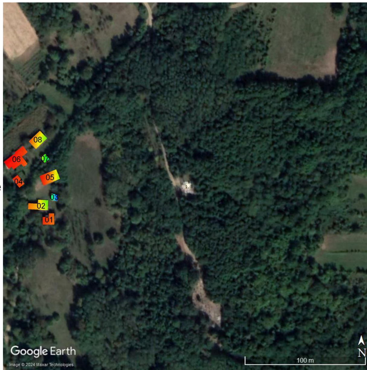
Слика 4.11. Јачина електричног поља унутар објеката када радио-систем LTE2100 оператора А1 Србија ради максималним капацитетом
