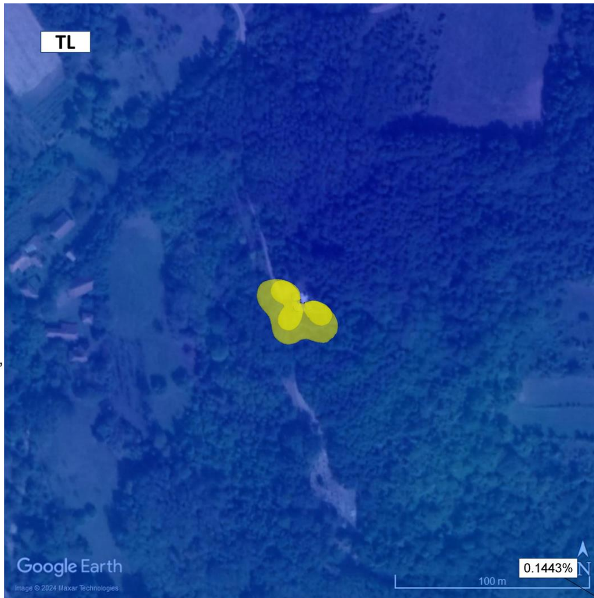
Слика 4.7. Фактор изложености на тлу када сви радио-системи свих оператора раде максималним капацитетом
